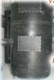
La désodorisation consiste à mettre en contact les pollutions odorantes avec une charge filtrante et absorbante.
